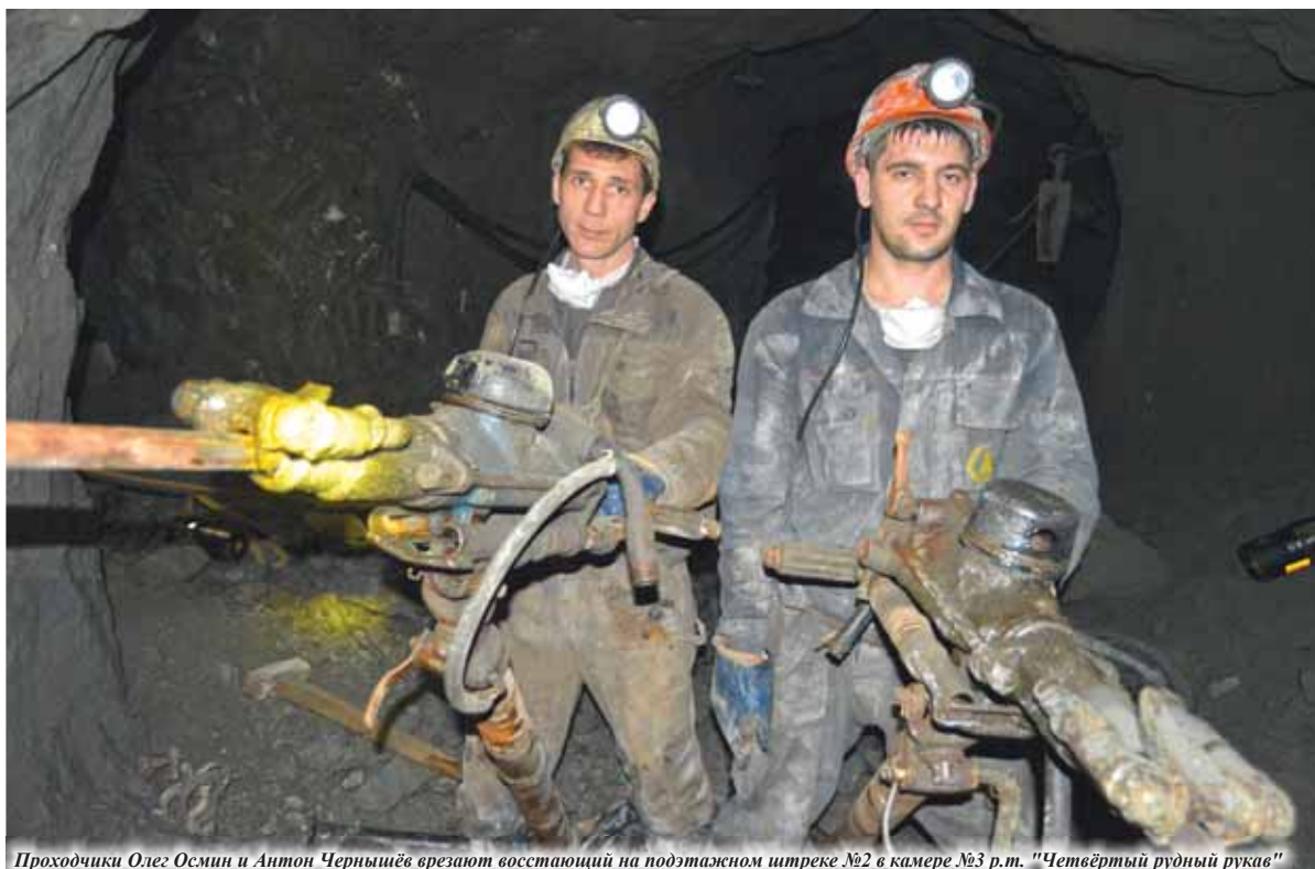
Проходчики Олег Осмин и Антон Чернышёв врезают восстающий на подэтажном штреке №2 в камере №3 р.т. "Четвёртый рудный рукав"
