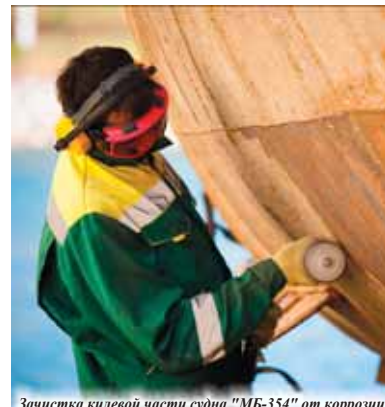
Зачистка килевой части судна "МБ-354" от коррозии
