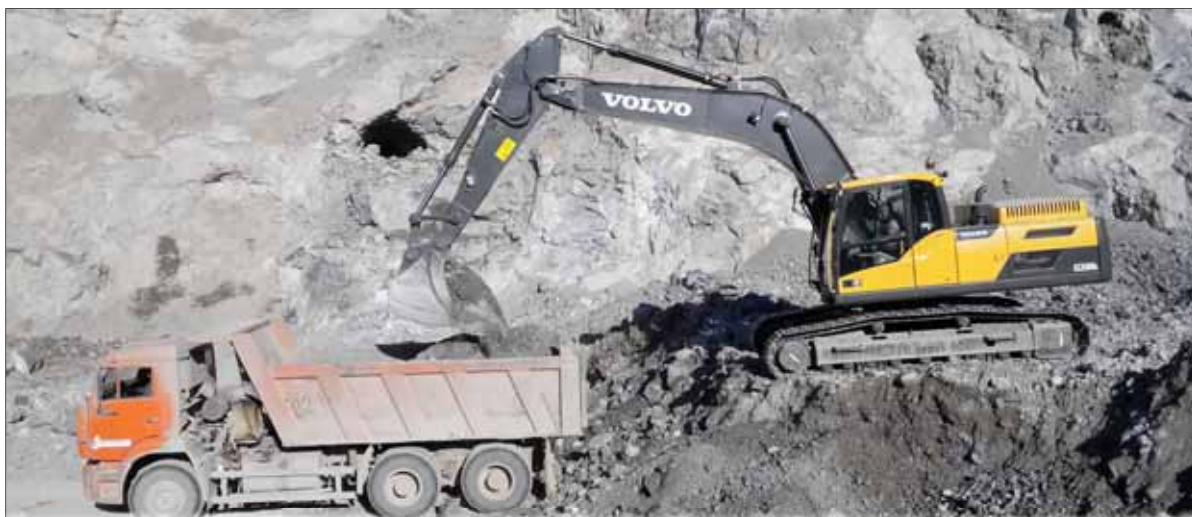
Экскаватор Volvo EC250DL на участке открытых горных работ рудника «Верхний» наполняет кузов самосвала рудой
